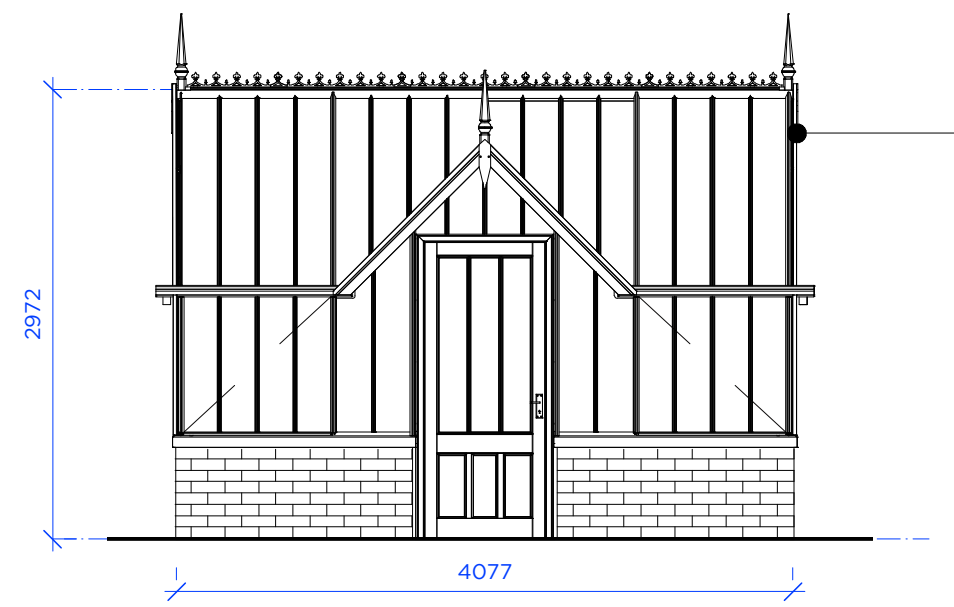
2 Greenhouse Front Elevation Scale: 1:50
